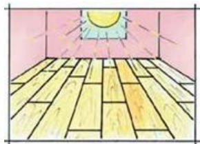
Asenna laudat päävalon suuntaisesti.
